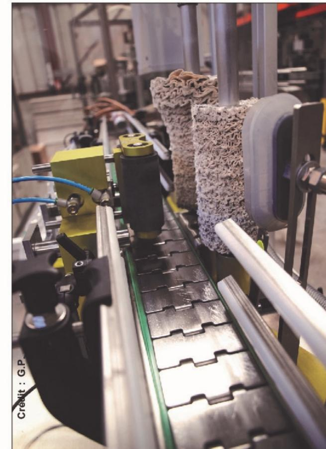
La lustreuse à bouteilles permet de remplacer le chiffon par une opération automatisée.
